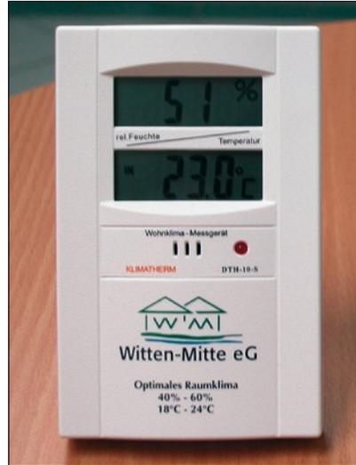
Um festzustellen, ob Temperatur und Luftfeuchtigkeit in der eigenen Wohnung im optimalen Bereich liegen, empfehlen wir ein **Wohnklima-Messgerät**. Bei Abweichungen meldet sich das Gerät automatisch mit einem Warnton und einer blinkenden Lampe.
